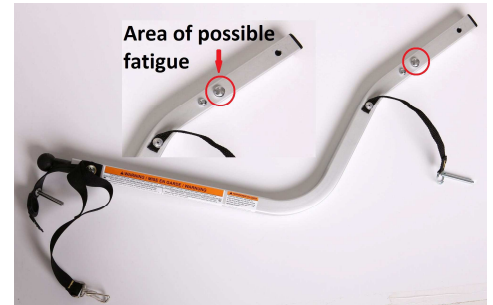
Figure 1. Zone de fatigue concentrée au niveau du bouton poussoir du bras d'attelage
