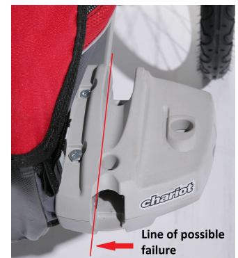
Figure 2. Ligne de défaillance probable des premiers modèles Versa Wing 2.0
